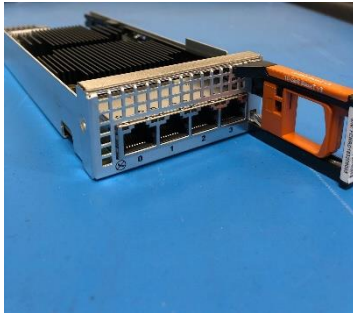
Figure 34. 10 GbE BASE-T I/O module
